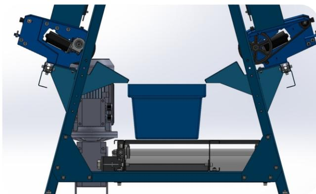
Для автоматического комплектования в каналах хранятся артикулы одной партии. Каналы расположены вертикально под небольшим уклоном над центральным ленточным конвейером и объединены в модули.
