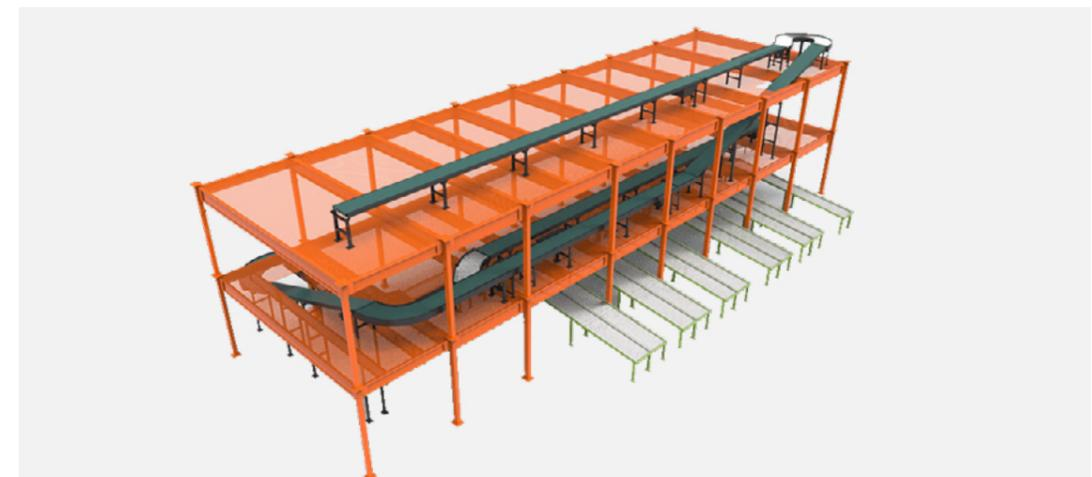
Конвейерная обвязка мезонина
