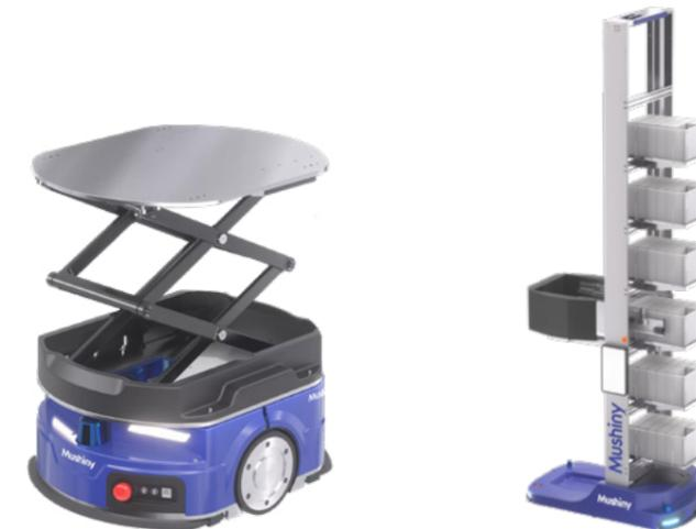
Робот AMR относится к автономному мобильному роботу - типу робота, предназначенного для навигации и самостоятельной работы в динамических средах. В отличие от AGV, AMR не используют фиксированные пути или магнитные полосы и более гибко адаптируются к изменениям задачи и маршрута в реальном времени. Роботы AMR используют датчики, камеры и алгоритмы для картирования окружающей среды, определения своего местонахождения и автономного избегания препятствий.
